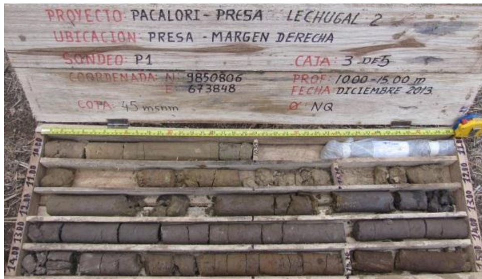
Figura 2.5: Perforación presa Lechugal 2 – Sondeo 1 Elaboración: PROMAS-Universidad de Cuenca, 2013.
