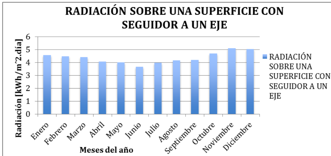
Ilustración 45. Valores de radiación para un seguidor a un eje. 54
