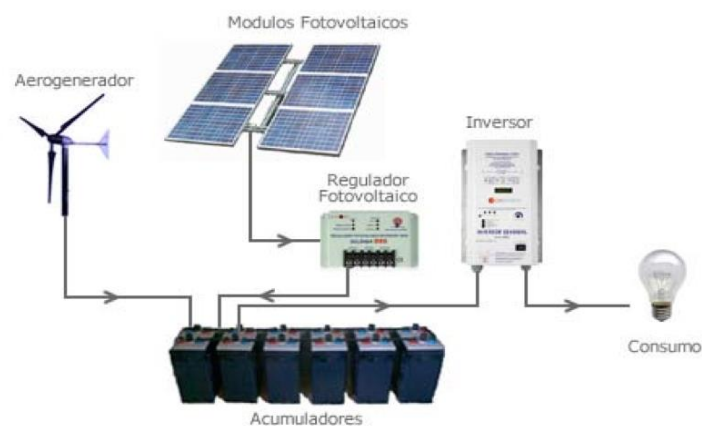
Ilustración 37. Configuración típica de un sistema híbrido. 46
