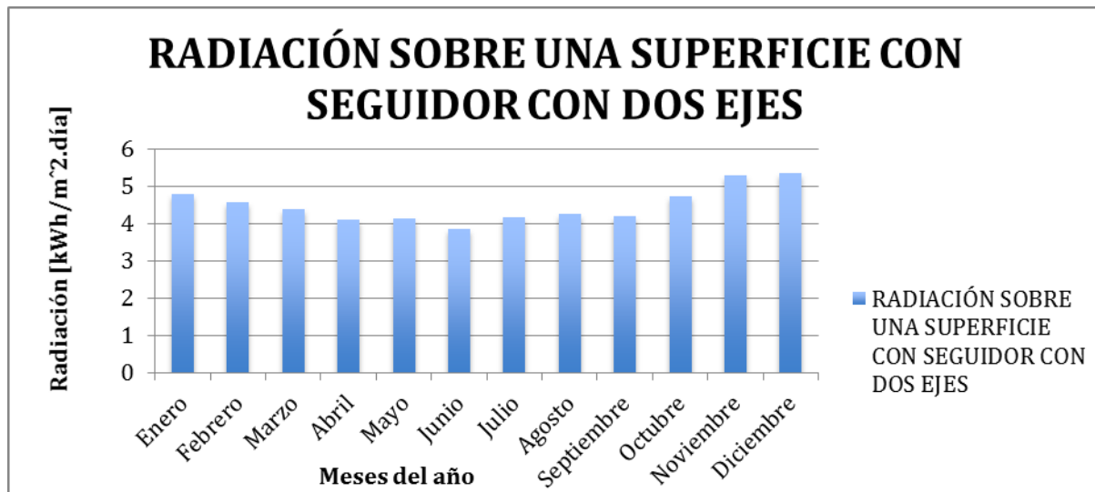
Ilustración 46. Valores de radiación para un seguidor con dos ejes. 56
