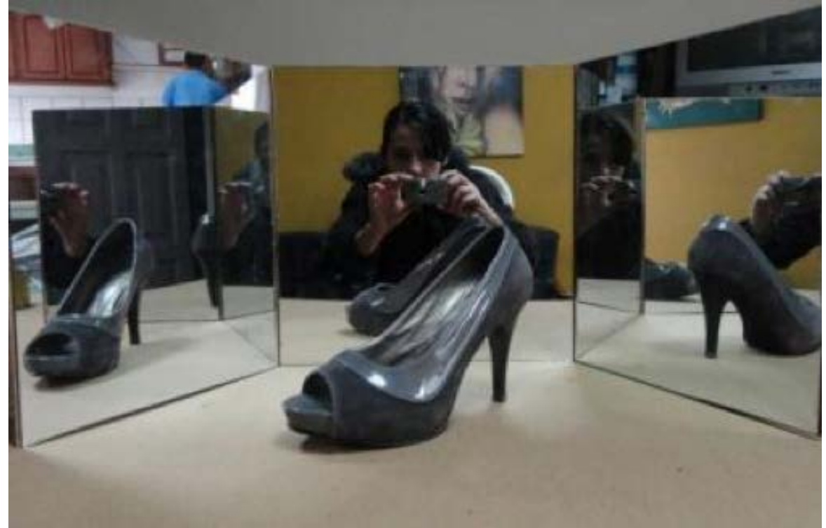
Espejos laterales con 120^\circ de apertura. Esta es la posición correcta que genera el efecto deseado y la que se utilizará en el proyecto.
