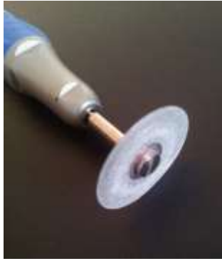
Fig. 8. Disco de diamante para corte. Autor: Gabriela Alvarado O. 2014
