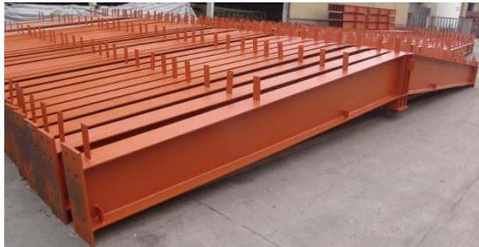
**Foto 31.-** Almacenamiento de vigas luego de su fabricación en taller.
