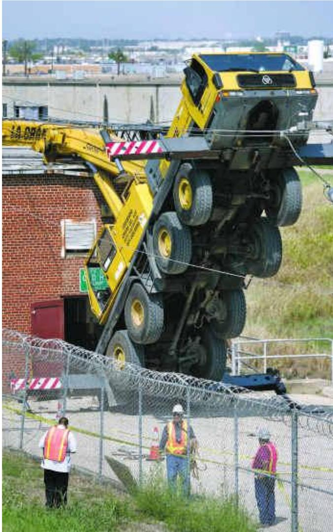
**Foto 37.-** Inconvenientes con grúas por mala operación, o por carga excesiva.
