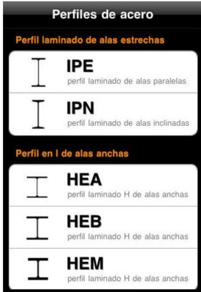
**Imagen 33.-** Imagen que muestra las diferentes vigas tipo “I” que se utilizan para edificaciones grandes e importantes.
