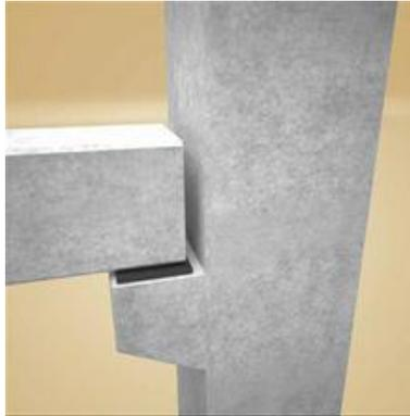
**Imagen 29.-** Esquema de unión de viga simplemente apoyada sobre columna con ménsula.
