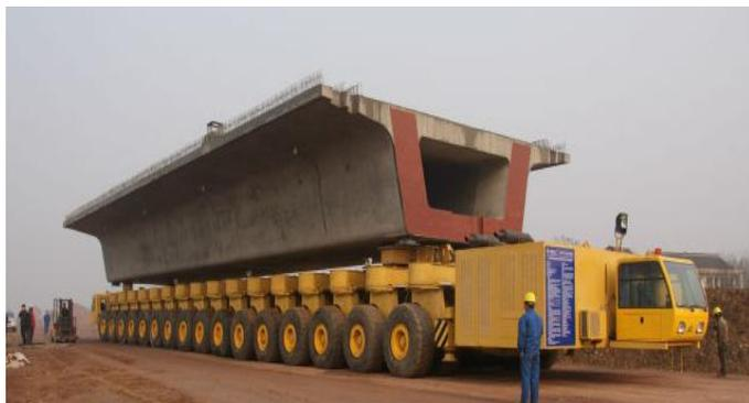
**Foto 40.-** Transporte especial para vigas de puente, varios ejes de llantas para distribuir el peso del elemento al suelo.
