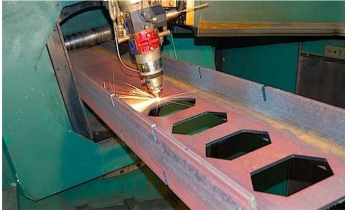
**Foto 30.-** Fabricación de vigas de acero en taller, bajo la mecanización y robotización.
