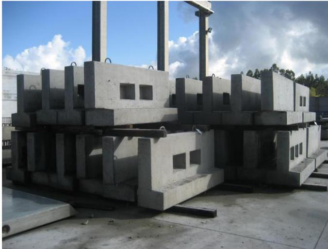
**Foto 79.-** almacenamiento de zapatas prefabricadas por APLIHORSA.
