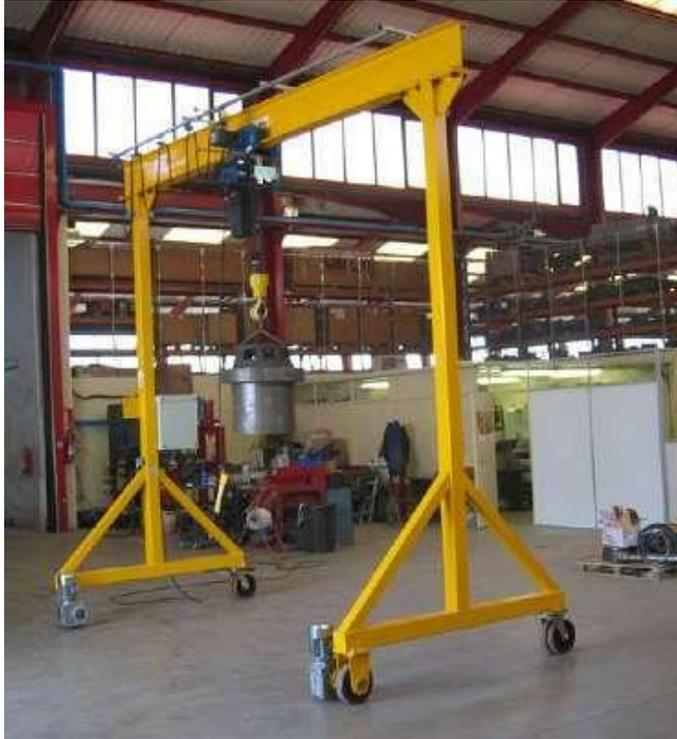
**Foto 32.-** Puente grúa pequeño, para movilizar elementos hasta de 5 toneladas en taller.
