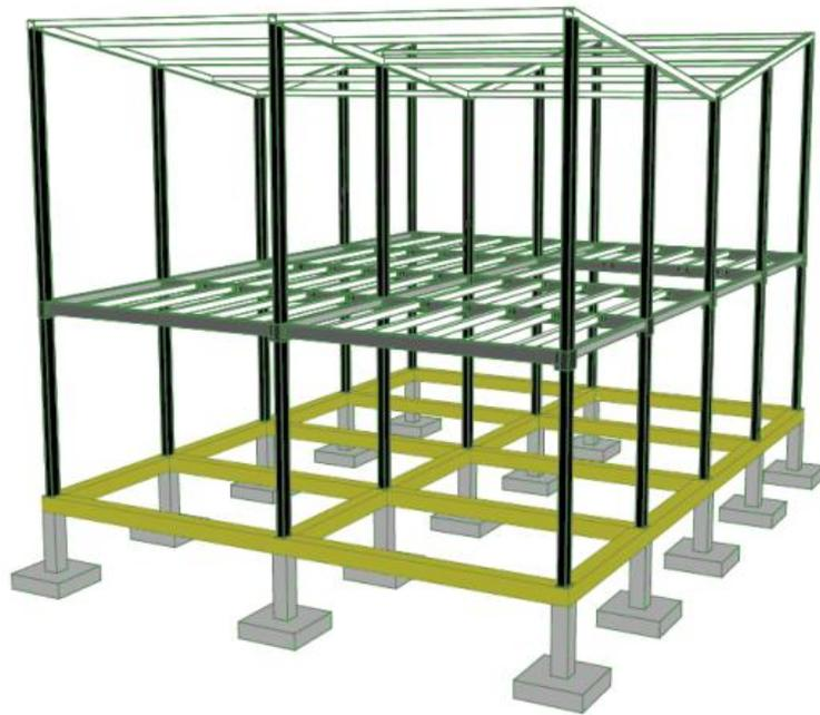
**Imagen 47.-** Esquema tridimensional de la estructura de acero conformada al frío y la estructura de cimentación.
