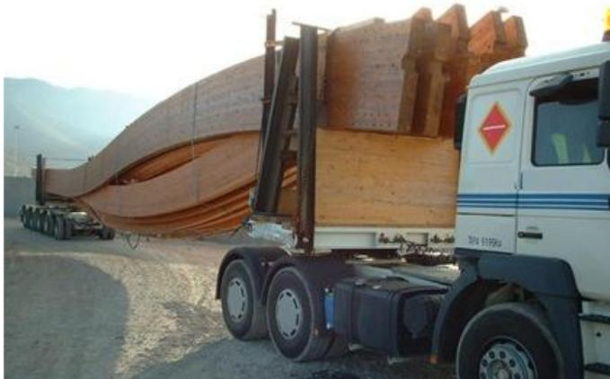
**Foto 41.-** Transporte especial para vigas largas de madera para la estructura de cubierta de un coliseo, apoyo delantero motriz y remolque posterior.
