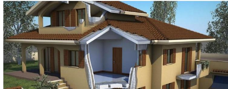
**Imagen 10.-** Modelo constructivo de una vivienda con sistema Hormi2.
