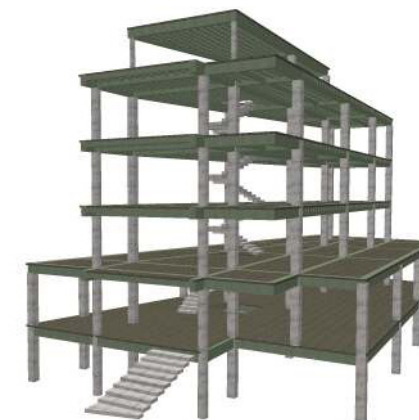
Gráficos 8. Estructura de hormigón armado del proyecto.
