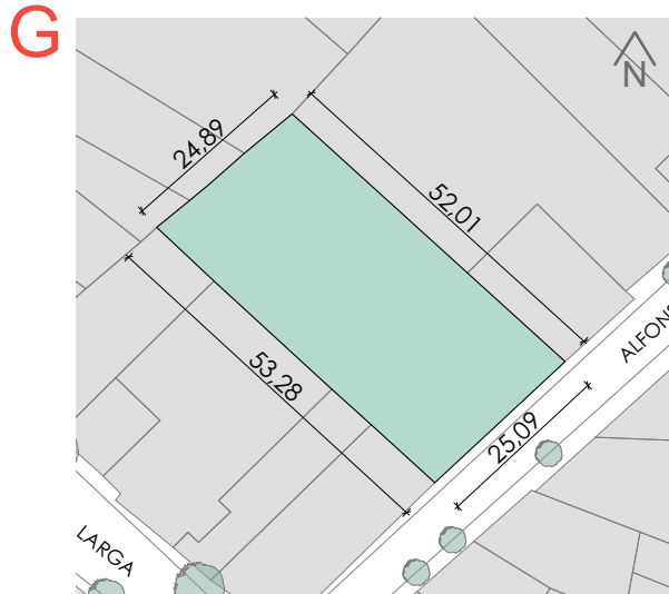
FIGURA 155. Planta de Lote. Posee una forma regular rectangular, con fondo de 53m y un frente de 25m.
