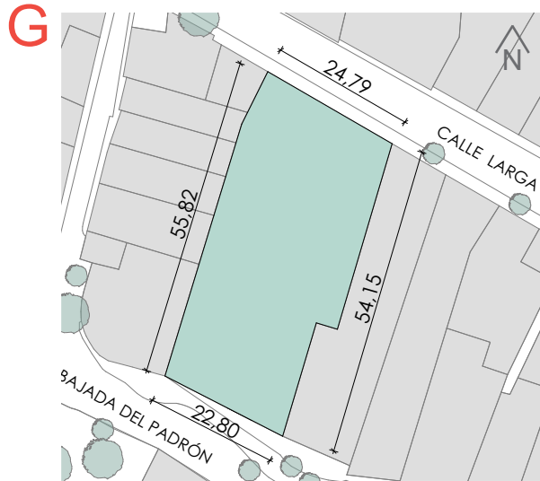
FIGURA 195. Planta de Lote. Posee una forma regular rectangular, con pendiente en el tercio, un fondo de 53m y un frente de 25m.
