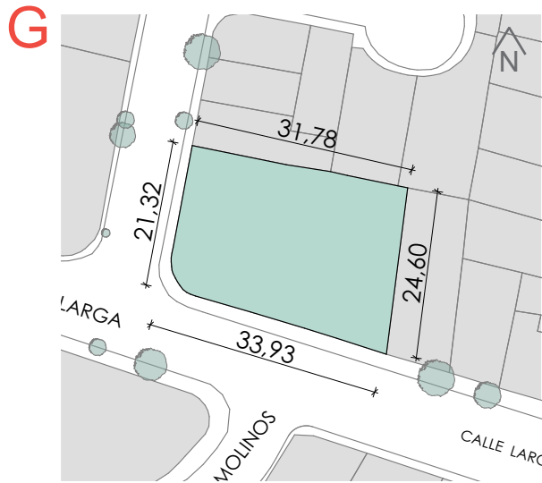
FIGURA 175. Planta de Lote. Posee una forma regular rectangular, con fondo de 23m y un frente de 33m.
