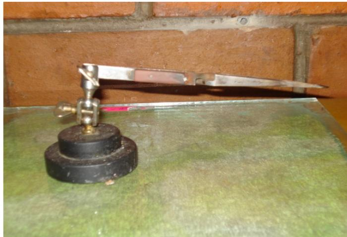
**Figura 59. PINZA AUXILIAR DE SOLDAR**
