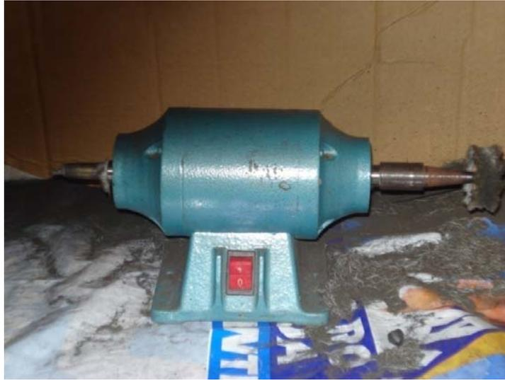
**Figura 6. MOTOR DE PULIR Y ABRILLANTAR**
