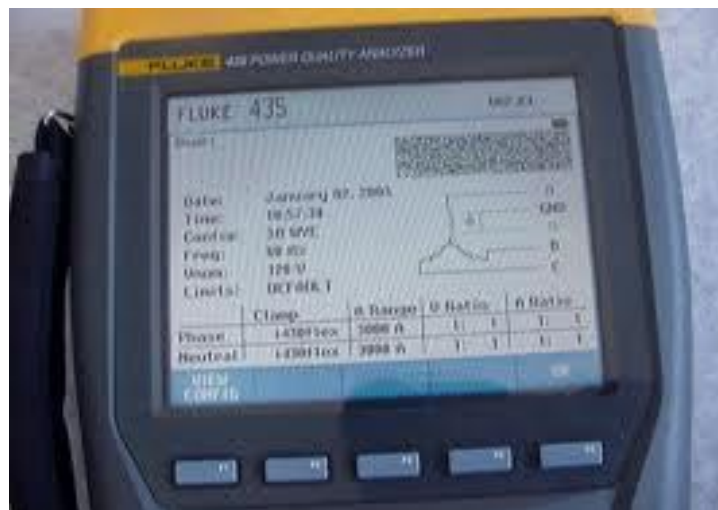
Figura 10. Analizador de Calidad de Energía Eléctrica.
