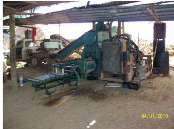
Se puede observar los motores, las alimentadoras, el laminador, la extrusora, las bandas transportadoras, y la cortadora.
