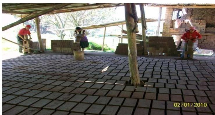
Artesanos realizando el raspado del ladrillo formando directamente pilones para seguir con la siguiente etapa de secado.
