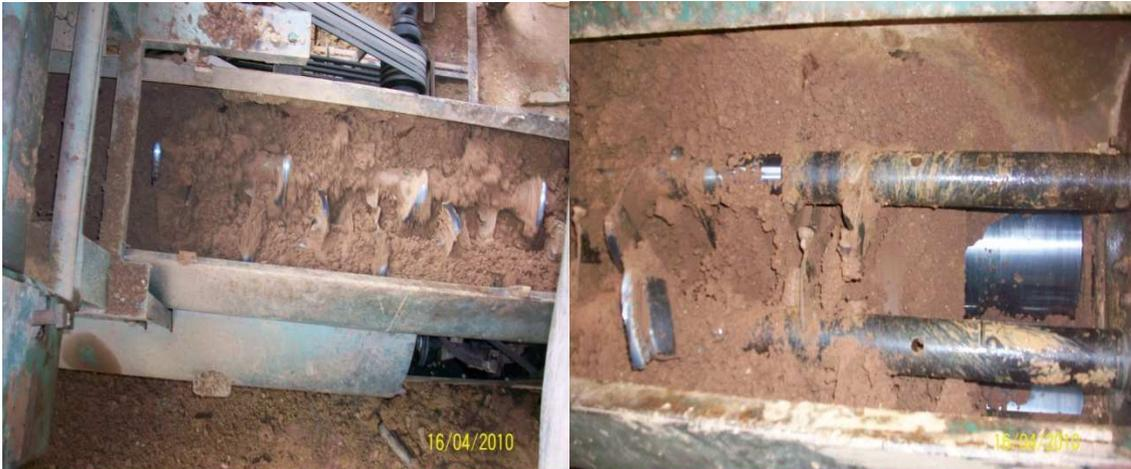
Transferencia por medio del laminador de dos cilindros y molido, hacia la extrusora
