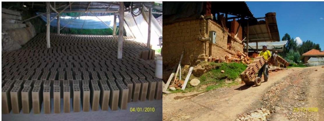
Ladrillos colocados en forma vertical para su secado recién salidos de la maquina; después de transcurrido un tiempo los obreros colocan en diferentes lugares al ladrillo para su alcanzar un secado más rápido.
