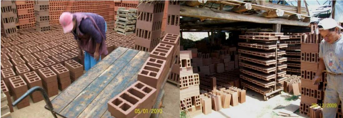
Artesana descargando ladrillos vistos desde el carro transportador para su secado, los mismos que son colocados en filas de montones y en los carros secadores.
