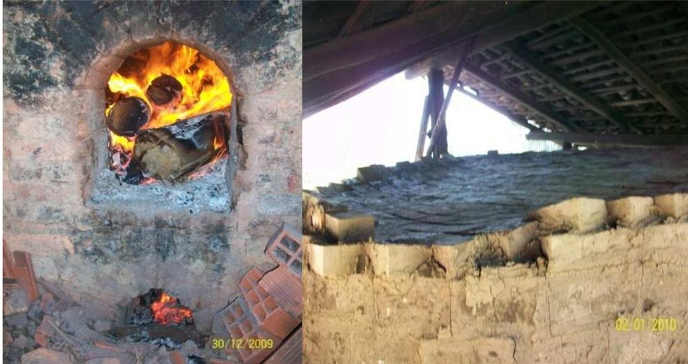
Momento en que es quemado los ladrillos, se introduce la leña por la boca del horno (segunda ventana). Se puede observar el carbón que cae en el cenicero (primera ventana). En la siguiente foto, se puede ver el efecto que causa la alta temperatura del horno recién quemado y tapado.
