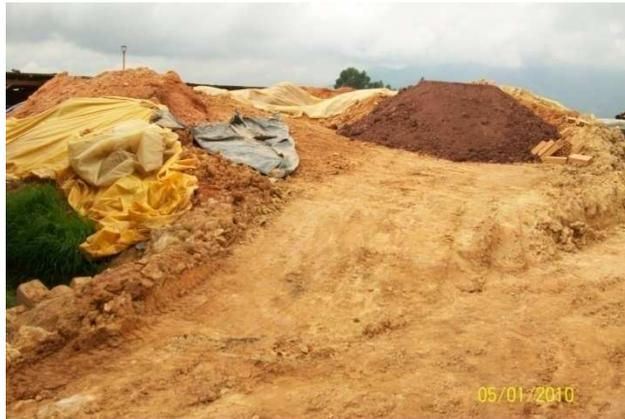
La unión de diversos tipos de arcilla para la mezcla que es humedecida uniformemente.
