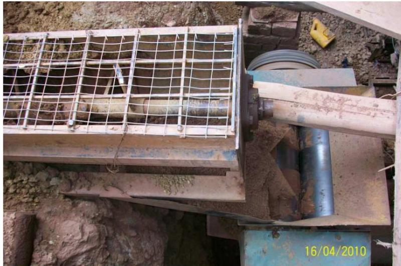
Tolva laminadora formada por 2 rodillos que tiene una separación de 3 milímetros
