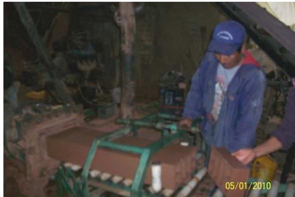
Artesano cortando el cuerpo continuo que sale de la extrusora, junto con otro cogiendo el ladrillo.
