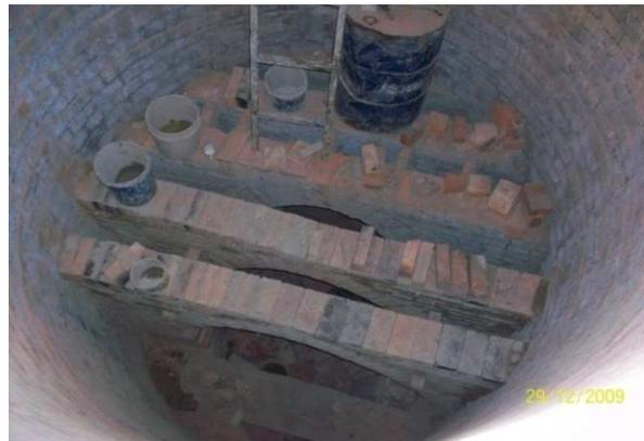
Horno redondo con arcos de ladrillo que sirven de soporte para el horneado y cocción del ladrillo.
