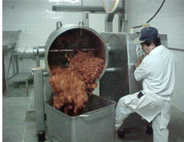
*PICADORA O MOLINO PARA CARNE FRESCA*: los trozos de carne son transportados por un rodillo sin fin y pasan por un complejo de pre-cortador, cuchillas o discos perforados. La carne sale molida, del tamaño de los agujeros que tenga la placa perforada. Algunas picadoras tienen como elemento auxiliar un dispositivo separador de nervios, cartílagos y trocitos de huesos.
