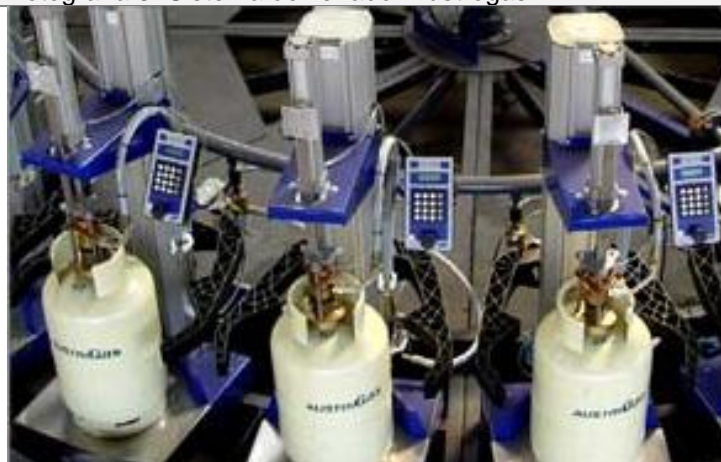
Fotografía 3: Sistema de llenado Austrogas.
