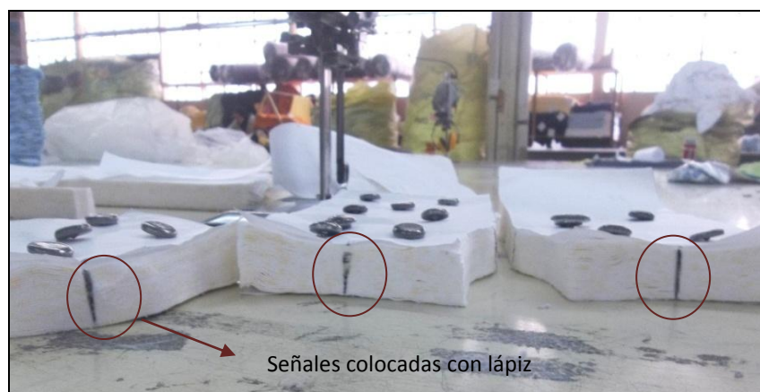
Fotografía 4.3: Señas colocadas en los cortes
