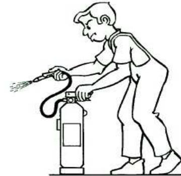
3. Presionar la palanca de la cabeza del extintor y en caso de que exista apretar la palanca de la boquilla realizando una pequeña descarga de comprobación.
