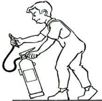
2. Asir la boquilla de la manguera del extintor y comprobar, en caso que exista, que la válvula o disco de seguridad está en posición sin riesgo para el usuario. Sacar el pasador de seguridad tirando de su anilla.
