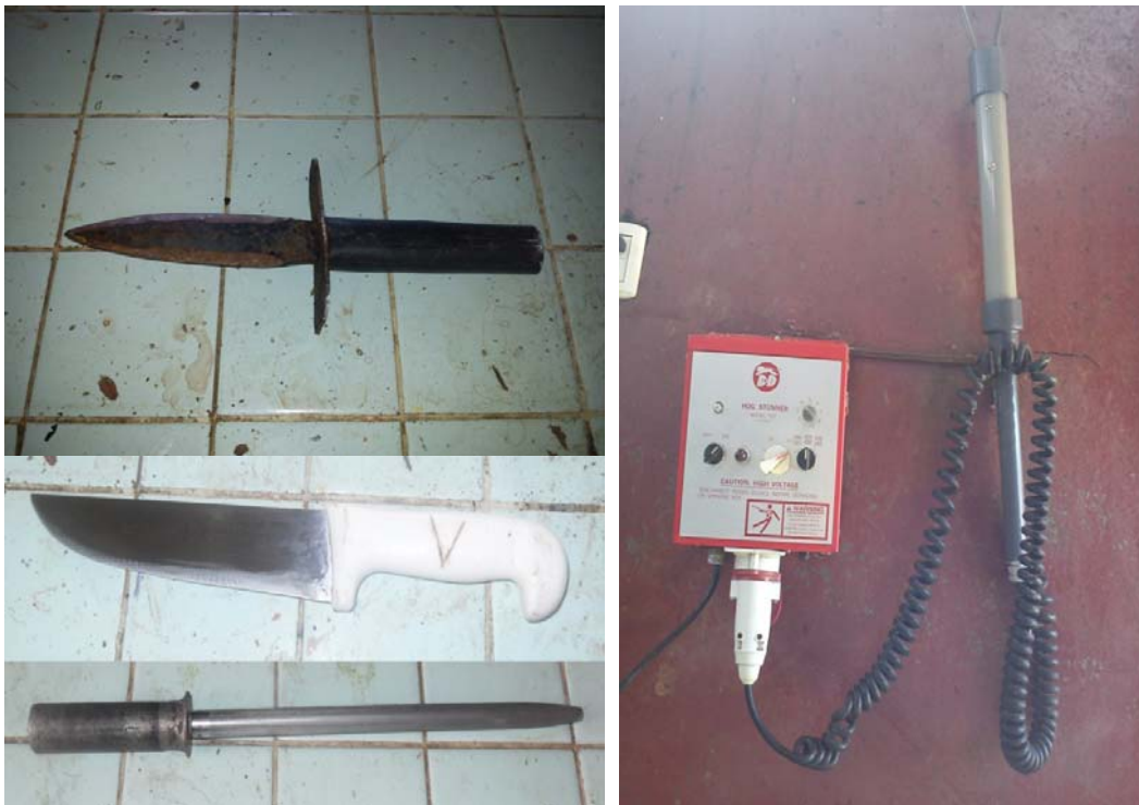
Gráfico 3.2: Equipo para la insensibilización y sacrificio (Puntilla, cuchillo, chaira e insensibilizador eléctrico).
