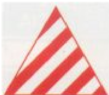
Esquema N°33: Señalización distintiva de extintores.
