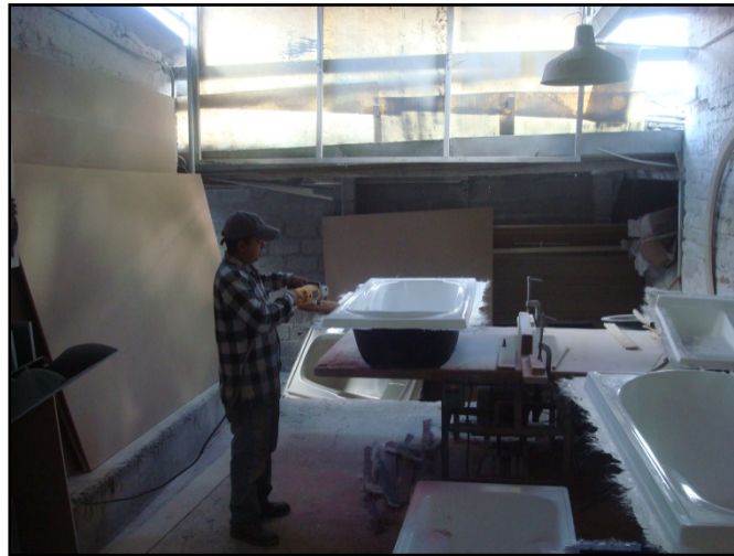
Fig. N°19. Proceso de perfilado.
