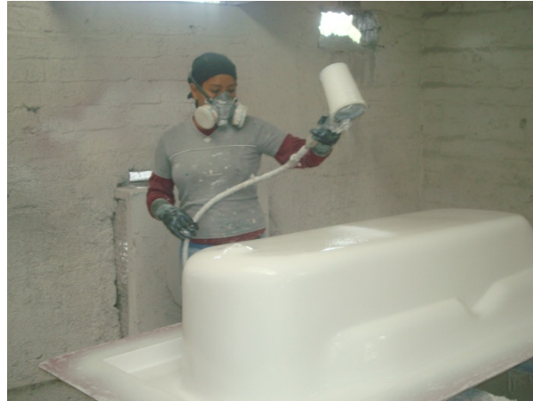
Fig. N° 24. Proceso de pintado de gelcoat.
