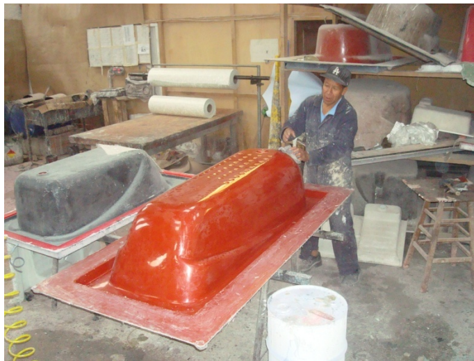
Fig. N° 22. Preparación del molde.
