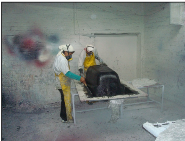
Fig. N° 23. Laminado en fibra de vidrio.
