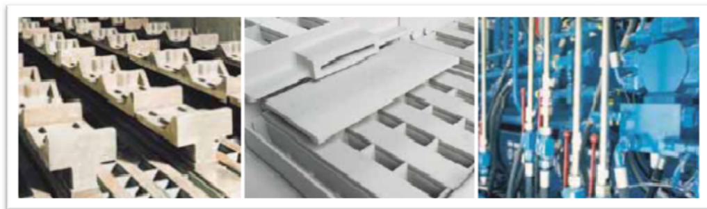
Figura 19 Elementos de transporte Del Enfriador De Clinker
