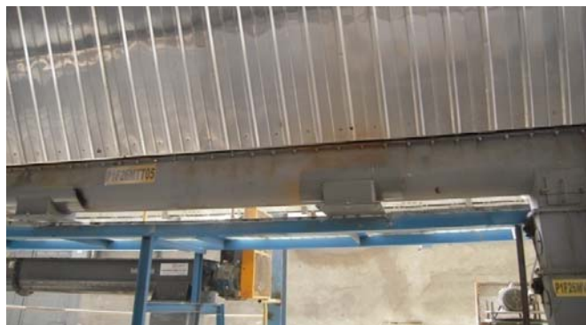
Figura 31. Tornillo sin fin filtro de mangas Fuente. Departamento de Procesos Compañía Industria Guapan
