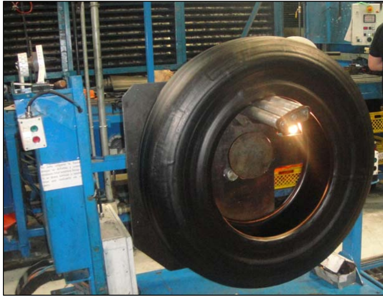
Foto 11: Estación de Inspección de llanta verde
