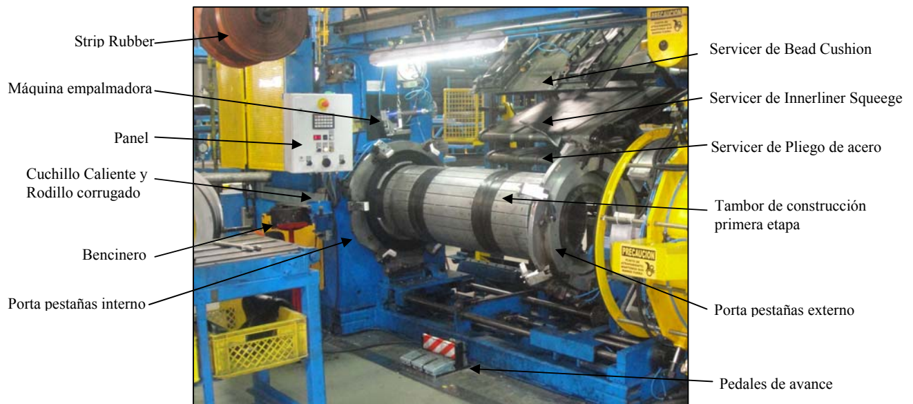
Foto 9: SAV: Construcción Primera Etapa
