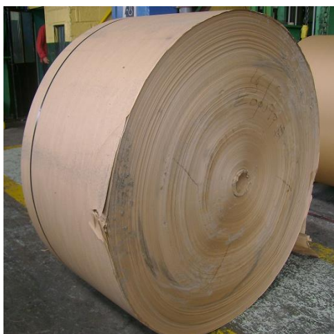
Figura.17. Daños por almacenamiento de Bobinas
