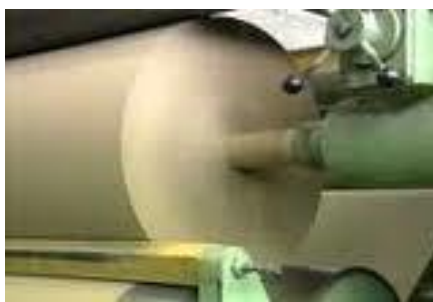
Figura.12. Elaboración de una bobina de papel
