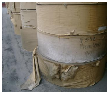
Figura.18. Bobinas Mojadas por el almacenamiento inadecuado
