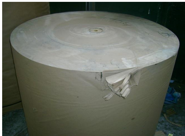
Figura.28. Bobinas con caras resacas
