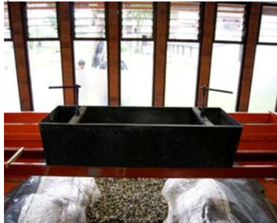
Imagen 3.5: Tolva para la Dosificación del Material (Pacheco & Carrillo, 2012)
