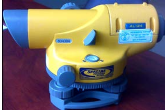
Imagen 3.6: Equipo de nivelación para control de pendientes
