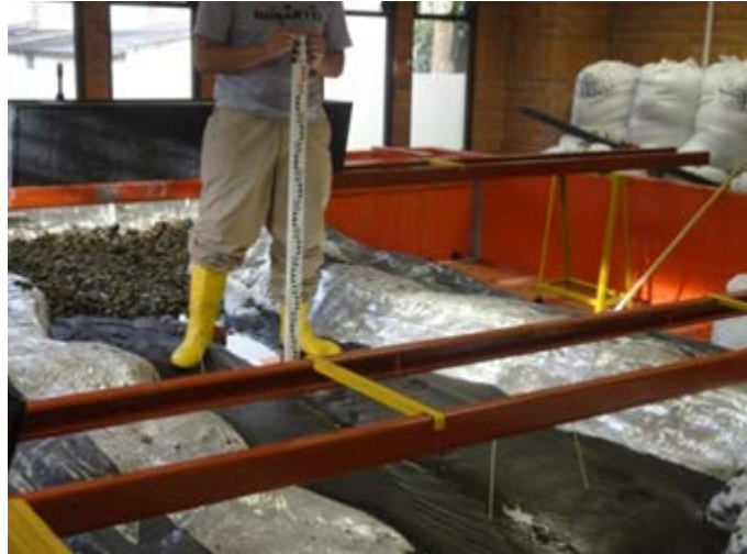
Imagen 3.7: Medición de pendientes en el modelo de escala reducida
