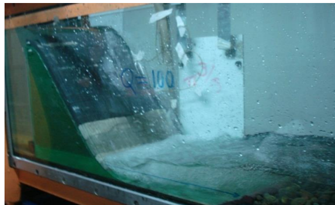
Foto 4.47 Azud sin escalones con Q=100\text{m}^3/\text{s}
