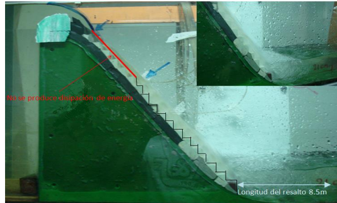
Foto 4.45 Disipador escalonado con Q=50\text{m}^3/\text{s}
