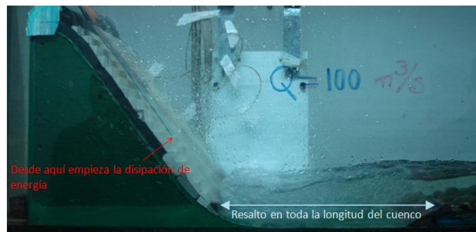
Foto 4.46 Azud escalonado con Q=100\text{m}^3/\text{s}
