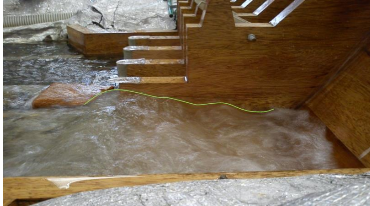
Foto 4.32 Ensayo con elevación del nivel del río sin dissipador SAF
