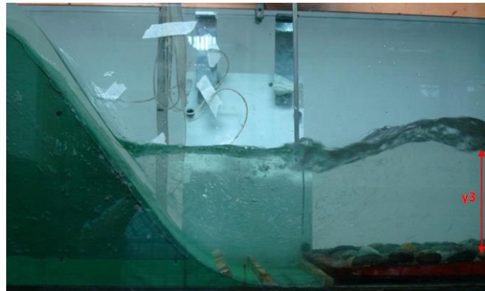
Foto 4.21 Disipador tipo SAF con cuenco; resalto sumergido
