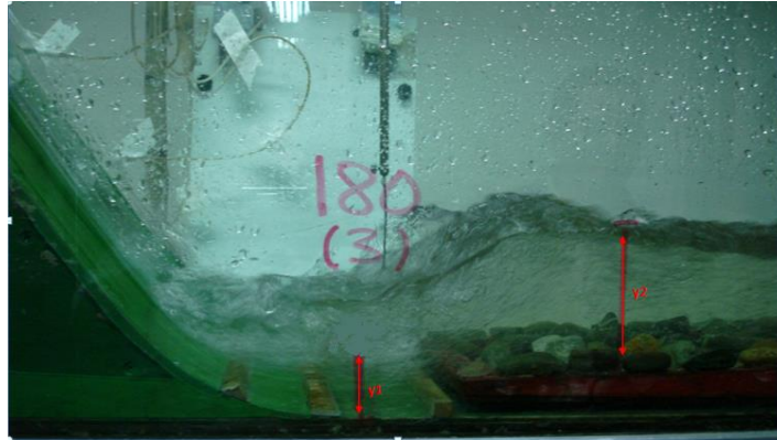
Foto 4.20 Disipador tipo SAF con cuenco; calado río 4m
