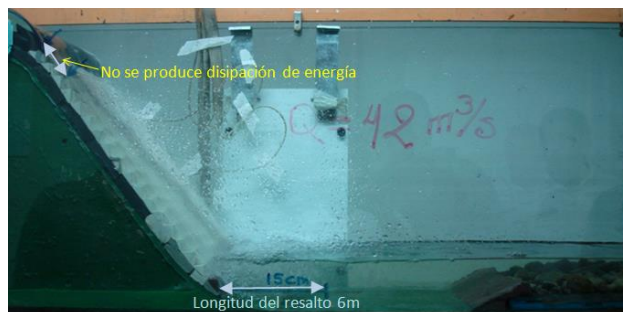
Foto 4.44 Disipador escalonado con Q=42\text{m}^3/\text{s}
