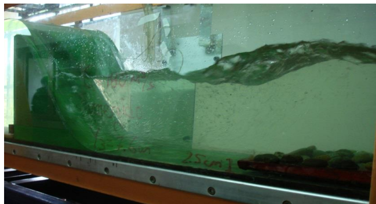
Foto 4.41 Caudal 180\text{m}^3/\text{s} ; resalto sumergido: y_3=7.6\text{m}
