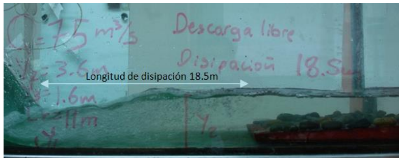
Foto 4.37 Caudal 75m 3 /s; descarga libre: y 3 =1.6m
