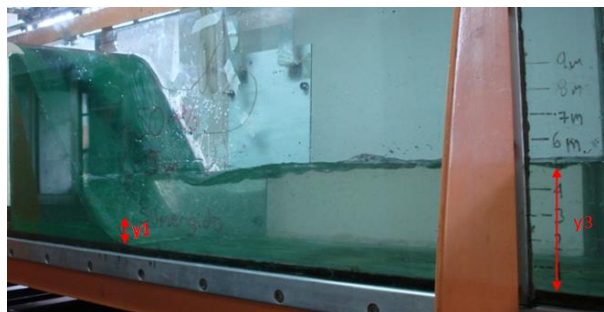
Foto 4.9 Caudal 50m 3 /s; resalto sumergido
