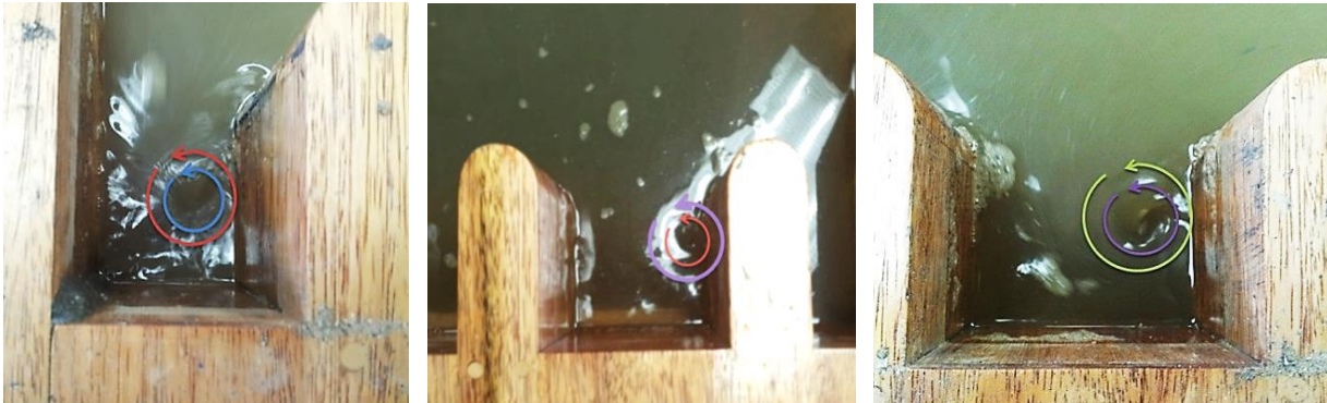
Figura 4.8. Formación de vórtices alrededor de las pilas
