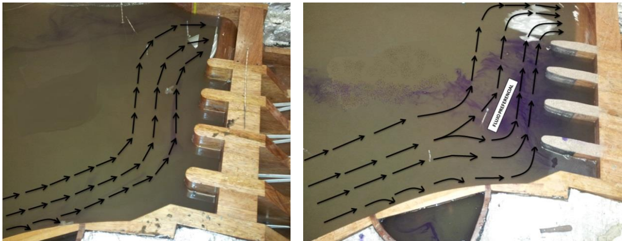
Figura 4.3. Flujo preferencial detrás de las compuertas
