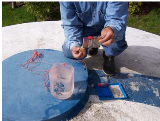
Foto VI-25 Operador midiendo el Cloro Residual en Tanque de Almacenamiento
