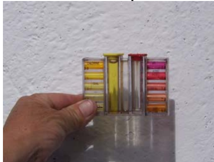
Foto VI-6 Equipo para medición de Cloro Residual
