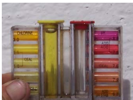
Foto II-29 Medidor de Cloro Residual
