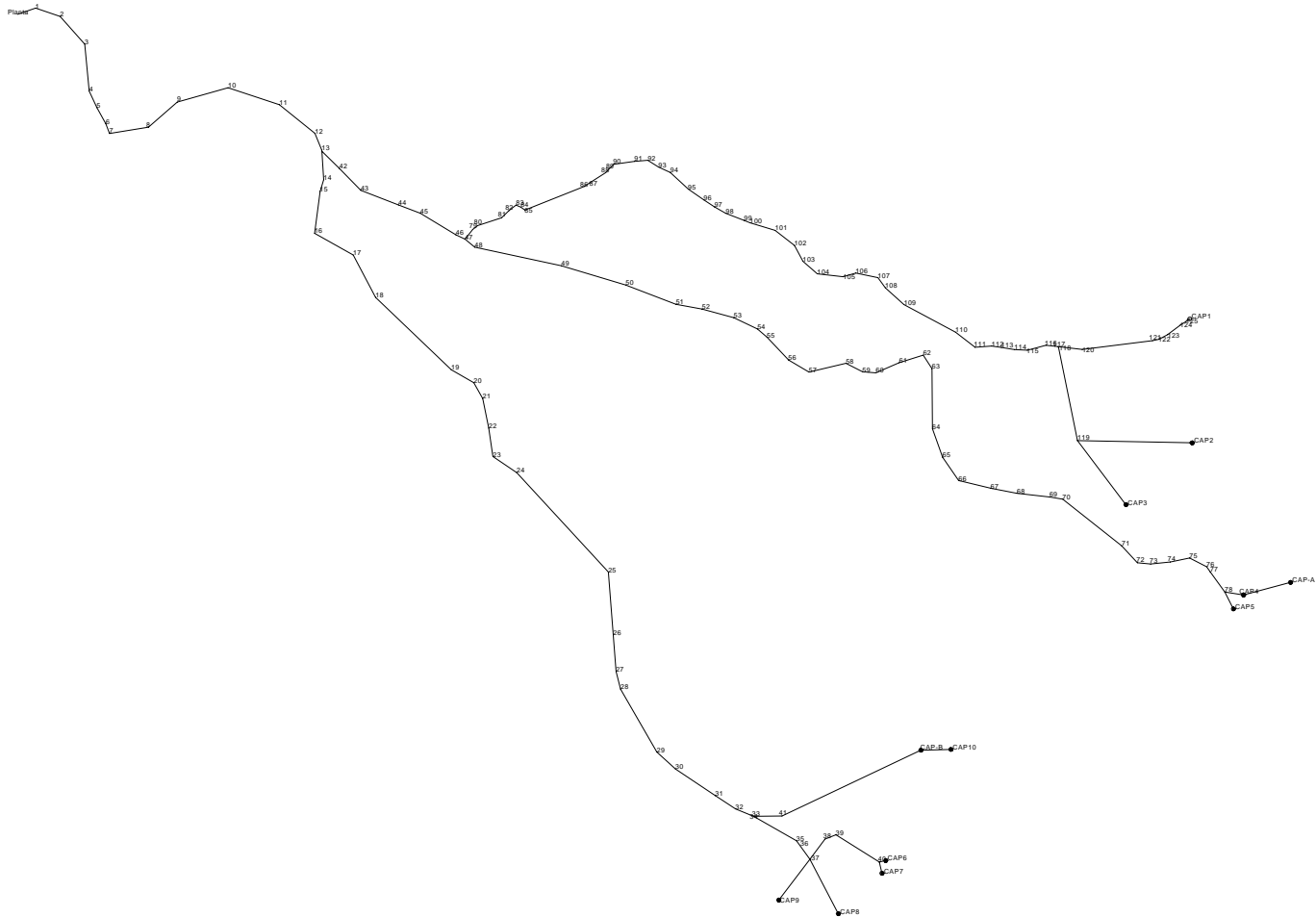
FIG.2-1 Esquema de Líneas de Conducción con los Nudos de Caudal del EPANET
