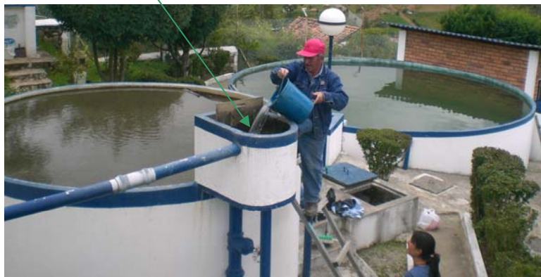
Foto VII-5 Adición del trazador en la cámara de entrada al filtro grueso
