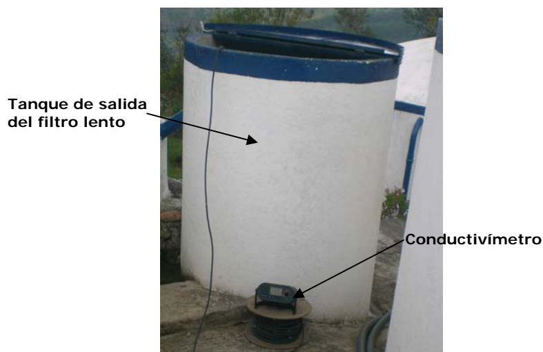
Foto VII-10 Medida de la conductividad en el tanque de salida del filtro lento a la salida del filtro lento
