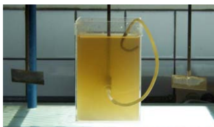
Foto VIII-18 Formación de Flóculos casi instantánea. Una vez transcurrido el minuto, se filtra la muestra a través del papel Wathman # 40. (Ver Foto VIII-19)
