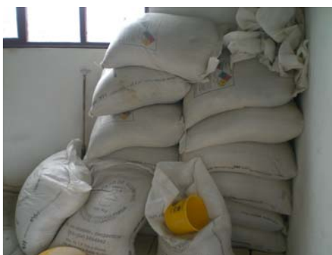
Foto X-45 Almacenamiento de Sulfato De aluminio en hileras sin espacios libres.
