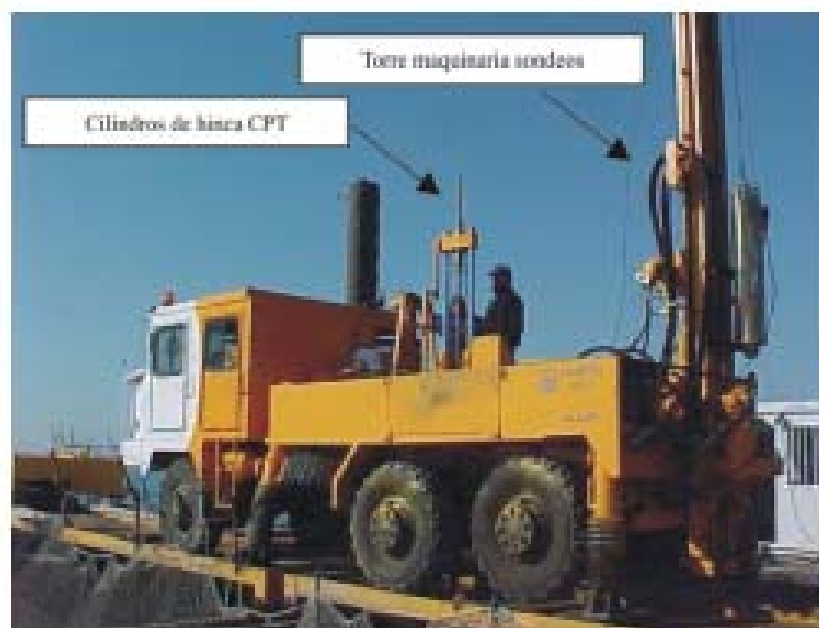
Figura 2.10 Equipo mixto de sondeos y ensayos CPT (Fuente: www.conepenetrationtest.com )
