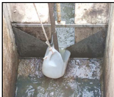
Figura 55: Determinación del caudal medido por el método volumétrico
