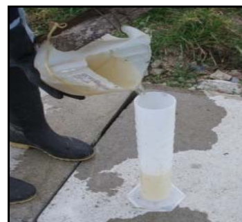
Figura 55: Determinación del caudal medido por el método volumétrico
