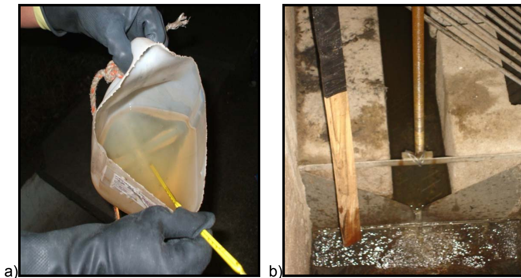
Figura 49: a) Determinación de temperatura, b) Medición de altura sobre el vertedero
