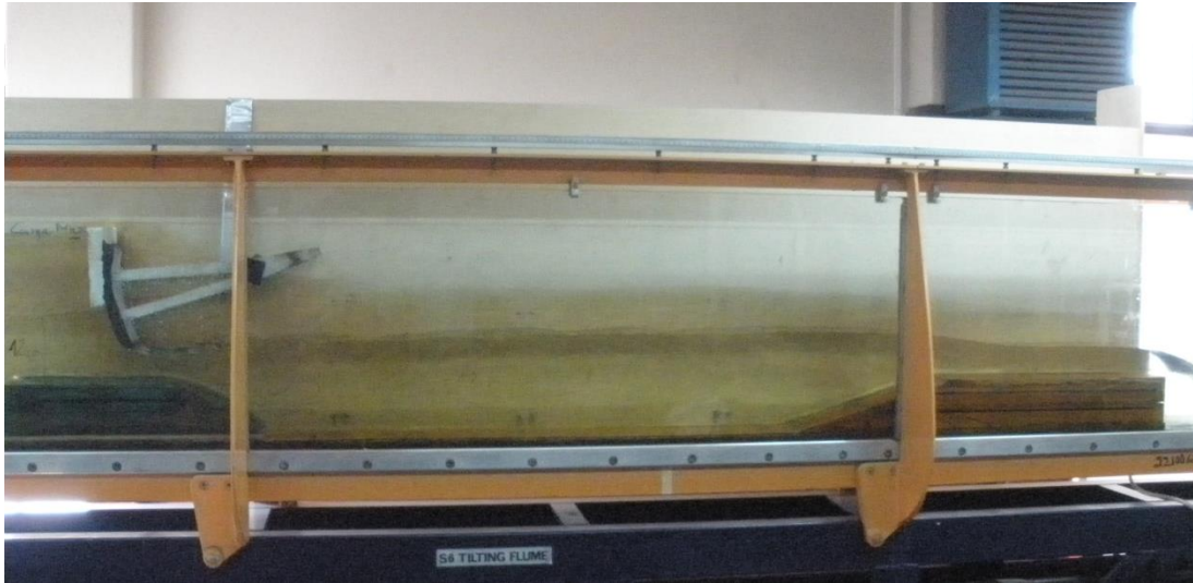
Figura 4-8. Alternativa 3: cuenco disipador USBR tipo IV-Modelo
