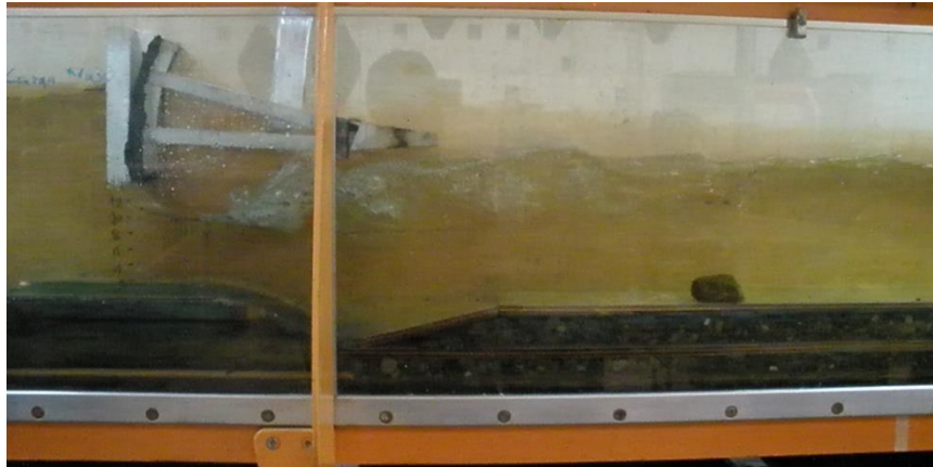
Figura 4-5. Alternativa 2 tipo cuña - Modelo
