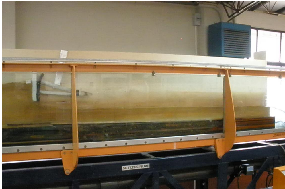
Figura 4-2. modelo de la Alternativa 1: USBR tipo I
