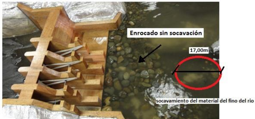
Figura 3-15. Enrocado después del ensayo. a=3\text{m} , 180\text{m}^3/\text{s} y v=11,88\text{m/s} de salida en el prototipo
