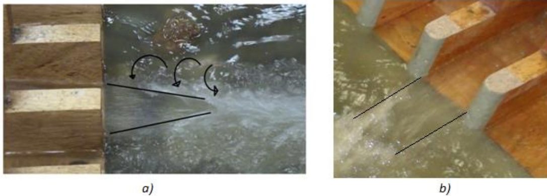
Figura 6-5. a) estructura original del cuenco sin pilas al final. b) estructura original del cuenco con implementacion de pilas al final.
