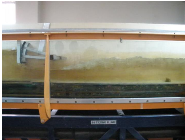
Figura 6-2. arrastre de material - descarga máxima alternativa 1
