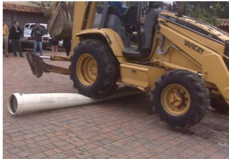
Fuente: Las investigadoras Figura 1.2 Prueba de resistencia de tubería de PVC Biax.
