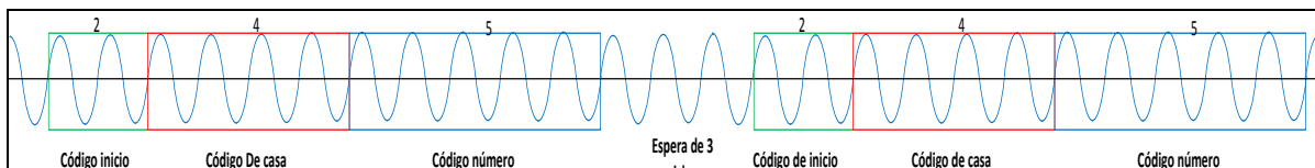
Figura 3.12 Transmisión completa de la trama X10
