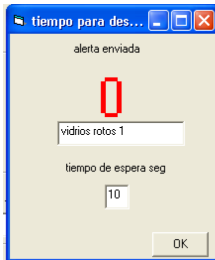
Figura 8.12. Cuenta regresiva para indicar una alarma
