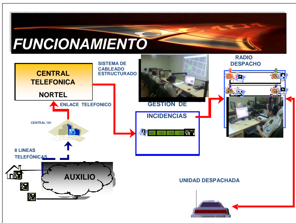
Figura 3. Funcionamiento de la central de emergencias de la central de atención ciudadana de la Policía Nacional
