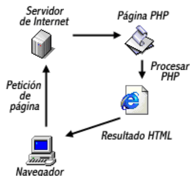
Fig. 1 Esquema de funcionamiento de las páginas PHP
