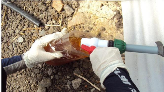
Tamizado de la muestra: se lo realizó en tela, separando la parte sólida de la líquida.
