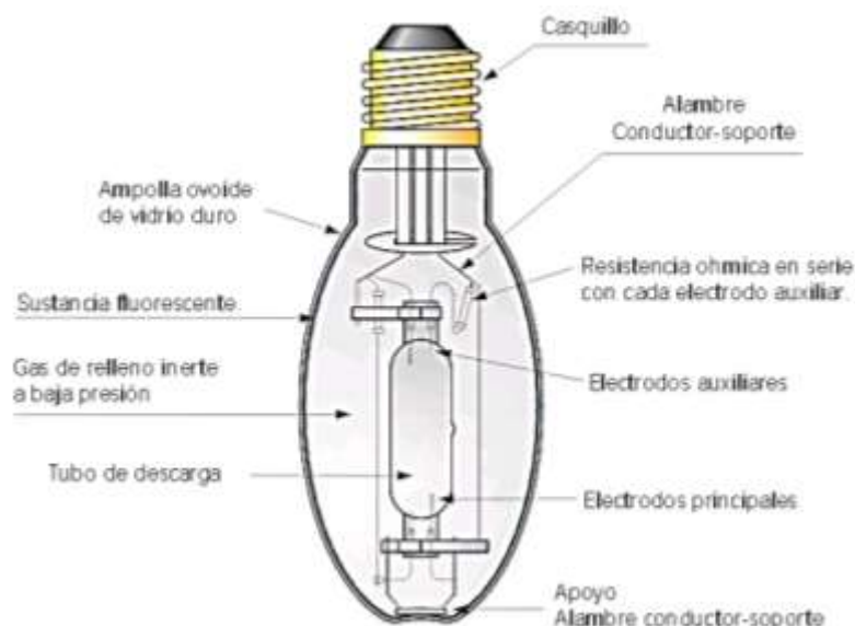
Figura 3.3. Lámpara de vapor de mercurio a alta presión.
