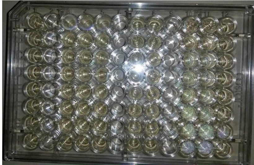
Fotografía 1. Placa una vez realizado el procedimiento de siembra e incubación a 35° C por 21 – 23 horas.
