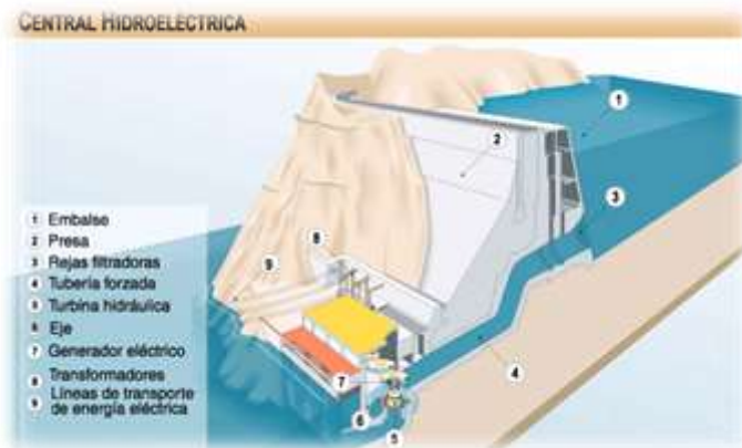
Imagen 2: Proceso de generación de energía eléctrica en una central hidroeléctrica
