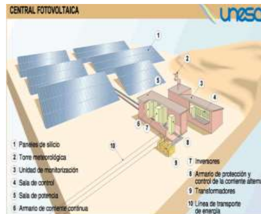
Imagen 5: Central Solar Fotovoltaica
