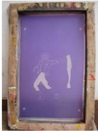
Mallas reveladas con cada uno de los colores a imprimir
