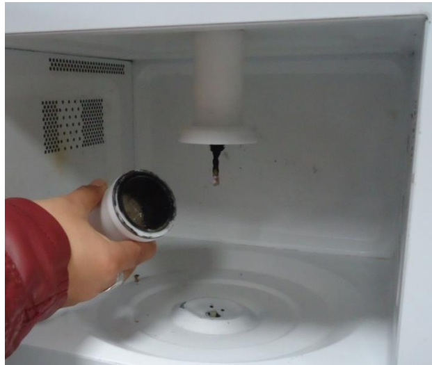
Figura 54. Reactor ennegrecido por quemaduras. Fuente: Las autoras.
