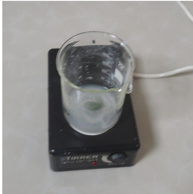
Figura 80. Agitación del gel con sulfato de aluminio. Fuente: Las autoras.
