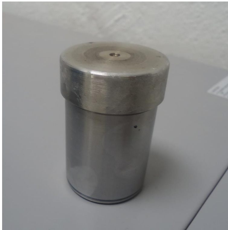
Figura 64. Reactor en acero inoxidable.
