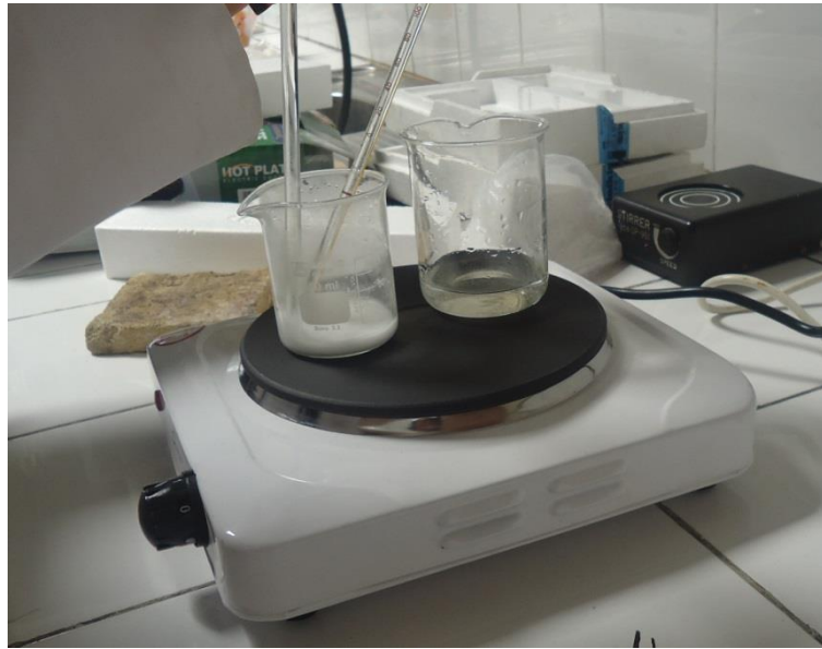
Figura 59. Preparación de gel con hidróxido de aluminio. Fuente: Autoras.
