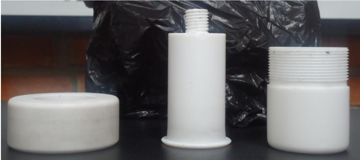
Figura 56. Reactor con nueva rosca. Fuente: Las autoras.
