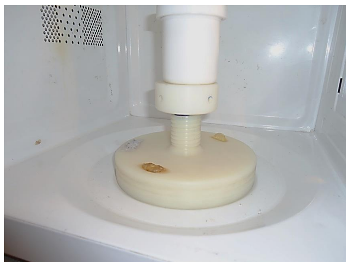
Figura 52. Soporte en poliamida con bombas de material fundido.
