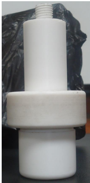
Figura 57. Reactor armado con nueva rosca. Fuente: Las autoras.
