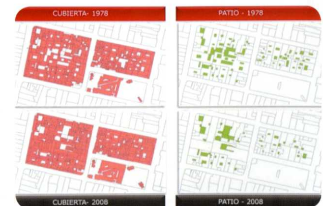
Rectificación fotográfica - GIS Comparación entre cubiertas y patios años 1978-2008
