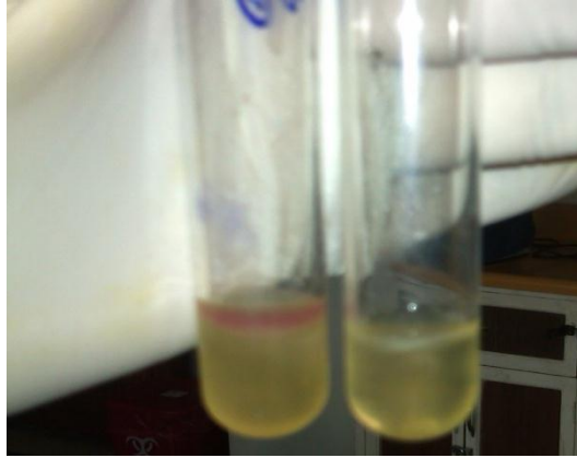
Ilustración 7: Prueba de Indol Positivo (Anillo rosado) Indol Negativo (sin color)
