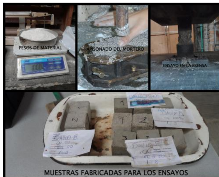
Ilustración 28: Ensayo de compresión simple en morteros de cal
