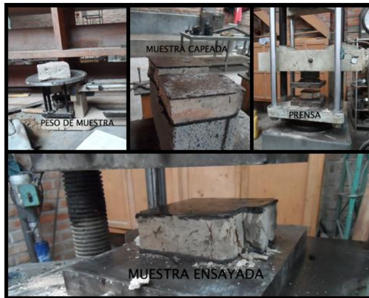
Ilustración 27: Ensayo de Compresión Simple sobre muestras de ladrillos
