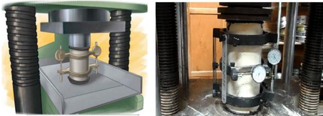
Ilustración 35: Ensayo módulo de Poisson
