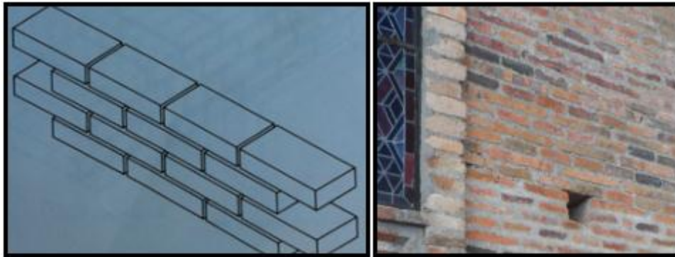
Ilustración 17: Posición de colocación de ladrillos
