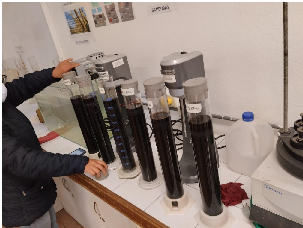
Figura 26. Preparación de la muestra para determinar el porcentaje de los agregados limo y arcilla
