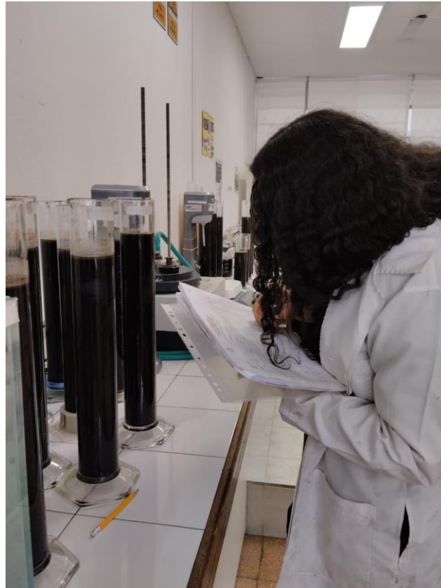
Figura 27. Toma de lectura de muestras para determinar la textura mediante el método de Bouyoucos.
