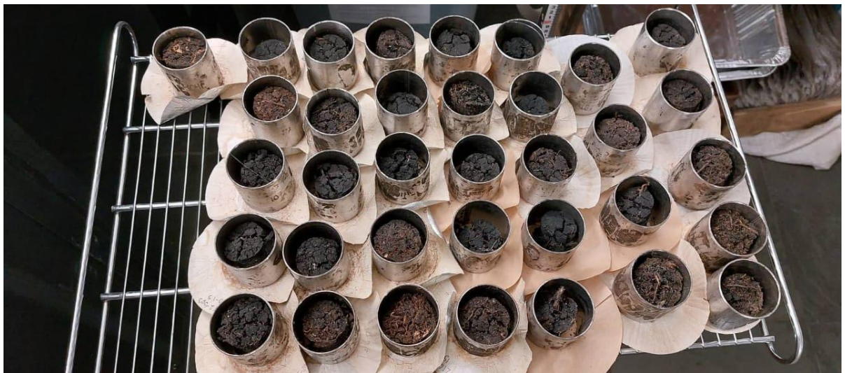
Figura 22. Muestras para determinar densidad aparente (Da)
