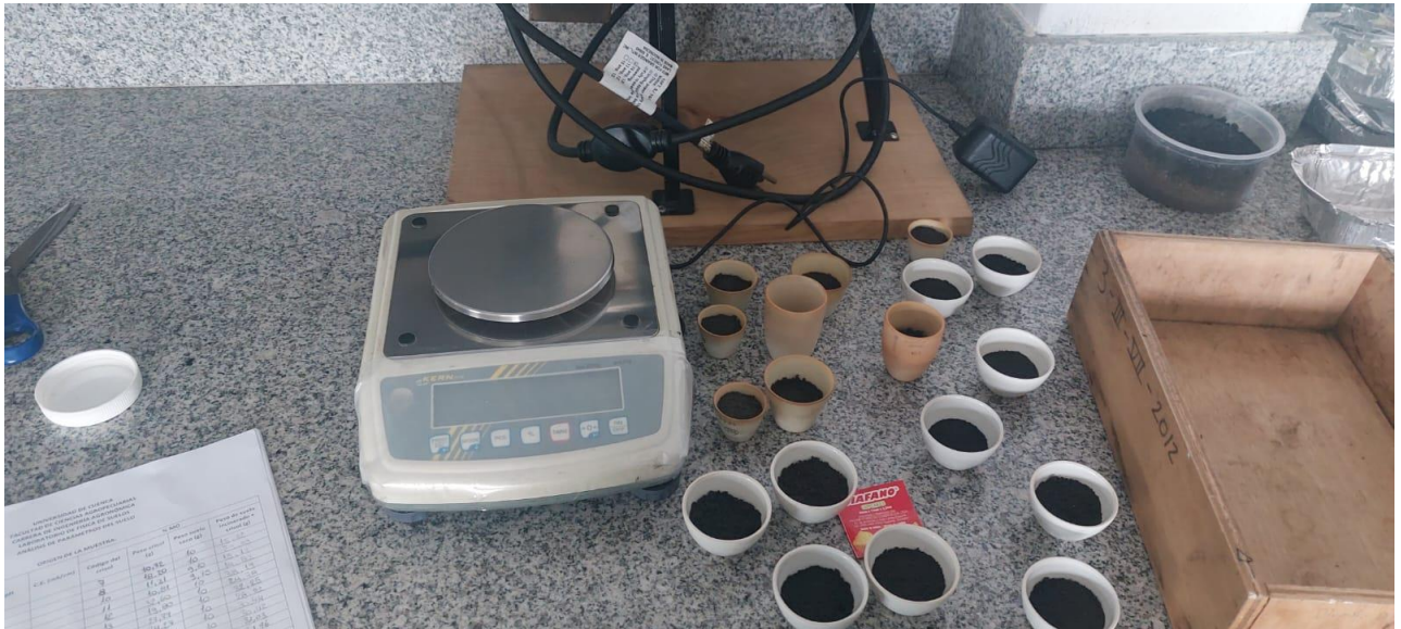
Figura 23. Muestras para determinar densidad aparente (Da)
