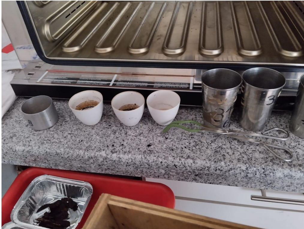
Figura 25. Procesado de arenas en el suelo para determinar su porcentaje
