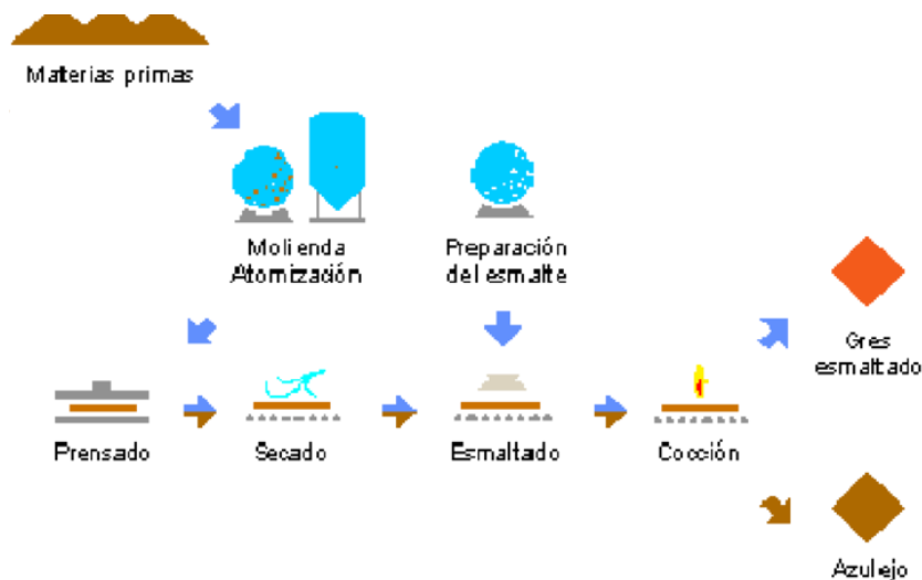
Figura 1: Proceso de fabricación de la baldosa cerámica por vía húmeda
