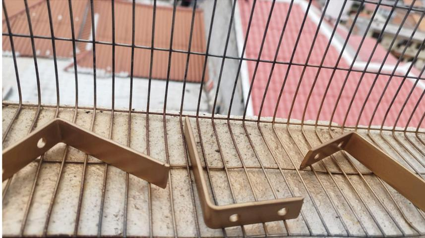
**Figura 21.** Pintura de soportes en ángulo
