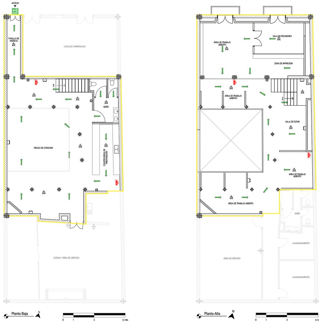
Figura 71 Planta de emergencia. Elaboración propia
