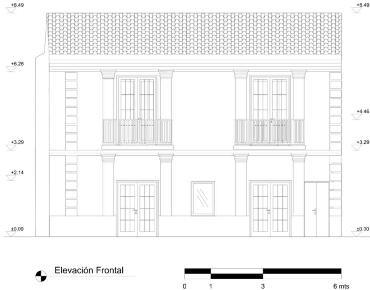
Figura 75. Elevación frontal. Elaboración propia
