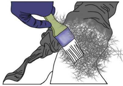
Figura 40: Aplicación de fibra de vidrio
