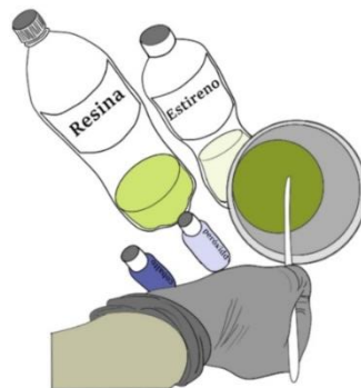
Figura 41: Mezcla de resina cobaltada con el peróxido
