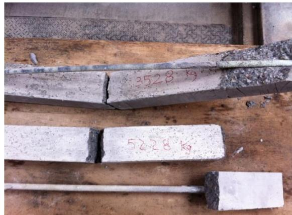
Figura 32: Rotura de vigas 2
