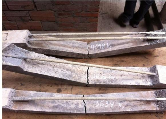
Figura 31: Rotura de vigas 1
