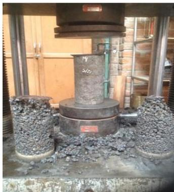
Figura 26: Ensayo de compresión simple
