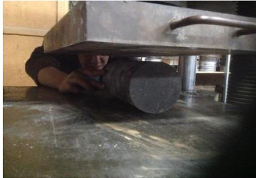
Figura 27: Ensayo de tracción indirecta
