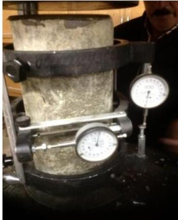
Figura 28: Medición de deformaciones
