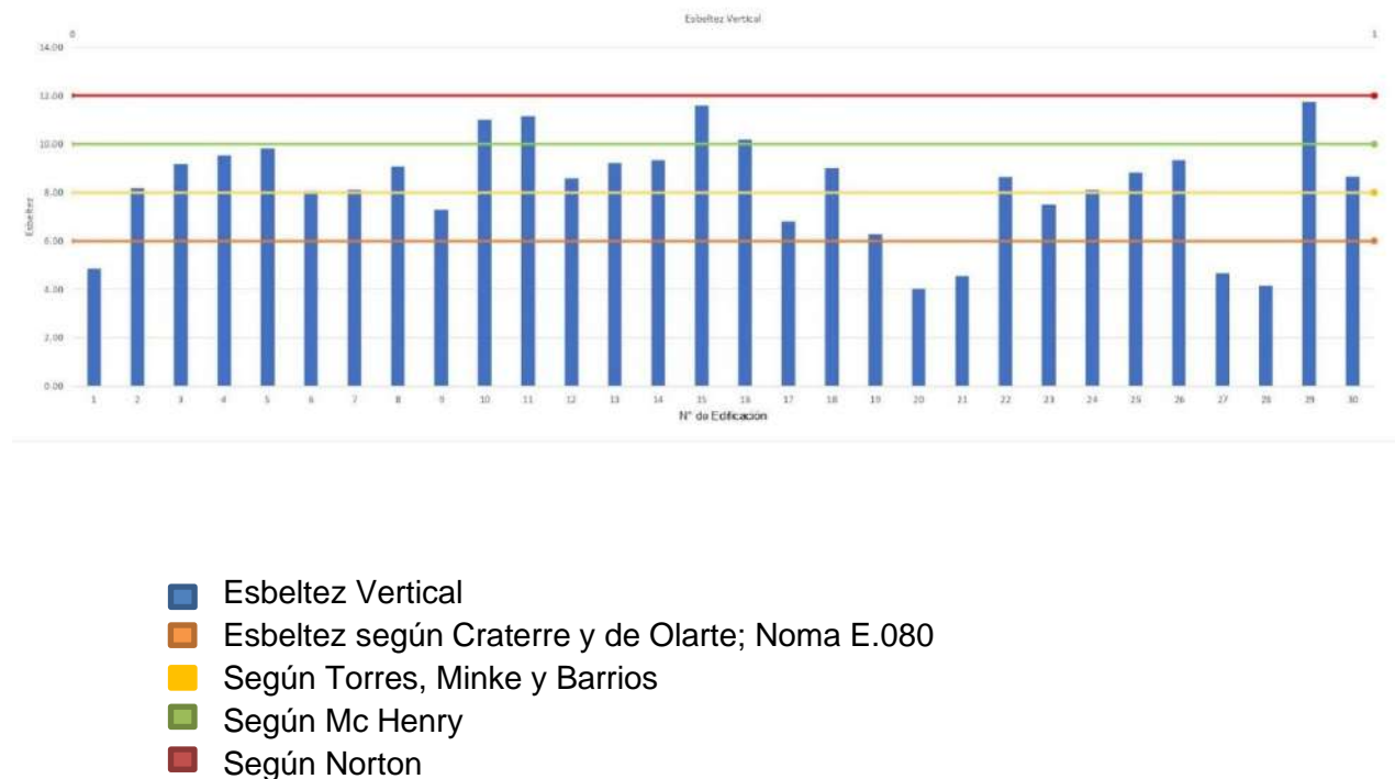
Figura 71. Comparación de la esbeltez vertical de las edificaciones según los valores establecidos en la norma E080 y según varios autores.
