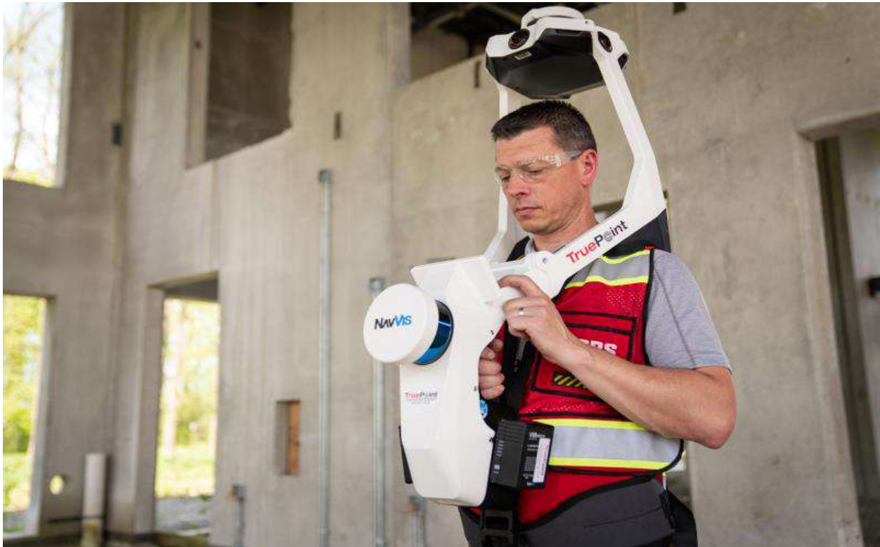
Figura 13. Ejemplificación del uso del equipo necesario para el uso del software NAVVIS Fuente de https://www.gp-radar.com/article/what-is-the-navvis-vlx-mobile-mapping-system-how-does-it-work
