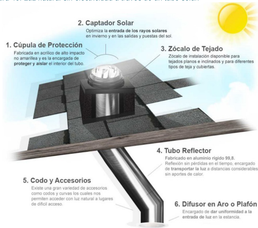
Figura 49. Luz natural sin electricidad a través de un tubo solar.
