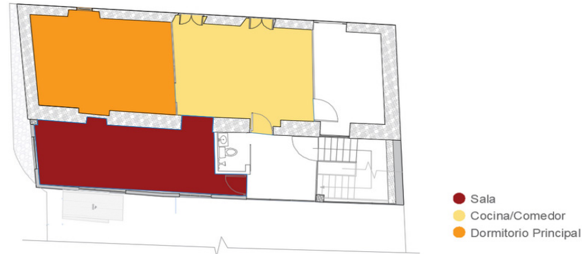
Figura 17. Zonificación espacios de permanencia en planta alta.
