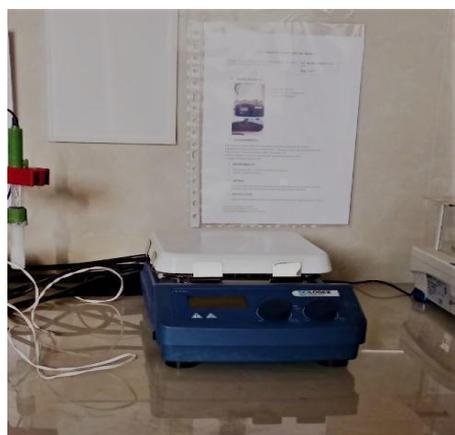
*Agitador digital de placa de cocción Scilogex MS7-H550-Pro 7x7 LCD.*
