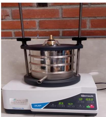
*Tamizadora analítica de la serie AS 200, tamices ASTM E11 con malla N° 60, 35, 18 ,amplitud controlada.*
