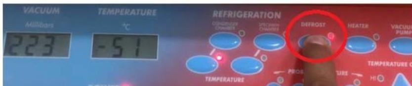
El descongelamiento se apagará automáticamente luego de un tiempo de estar encendido, si el hielo de la cámara de condensación no se ha descongelado completamente se deberá encender nuevamente el descongelamiento presionando el botón “DEFROST”.
