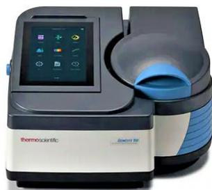
*Espectrofotómetro Vis/UV-Vis GENESYS™ 140/150, marca Thermo Scientific™ 840-300300.*
