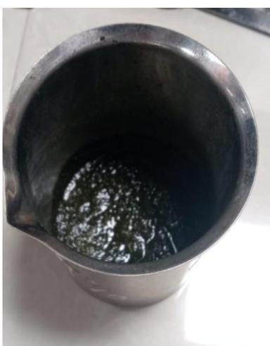
*Vaso de precipitados de acero inoxidable con el hidrolizado resultante.*
