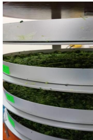
*Colocación de materia prima en bandejas del equipo de liofilización.*
