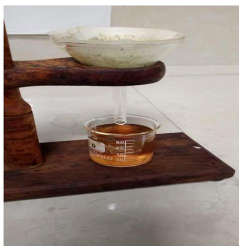
*Filtración del hidrolizado resultante.*
