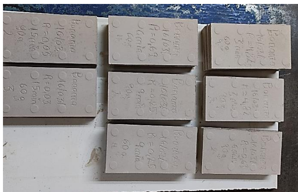
Figura 10. Placas prensadas y crudas.
