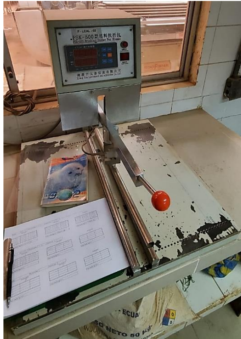
Figura 12. Equipo para la determinación del módulo de rotura (Xiang Tan Instrument and Apparatus Co / PSK-500)
