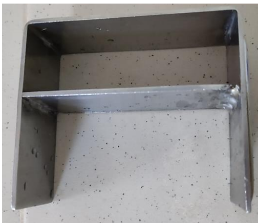
Figura 6. Trineo empleado para la elaboración de franjas.
