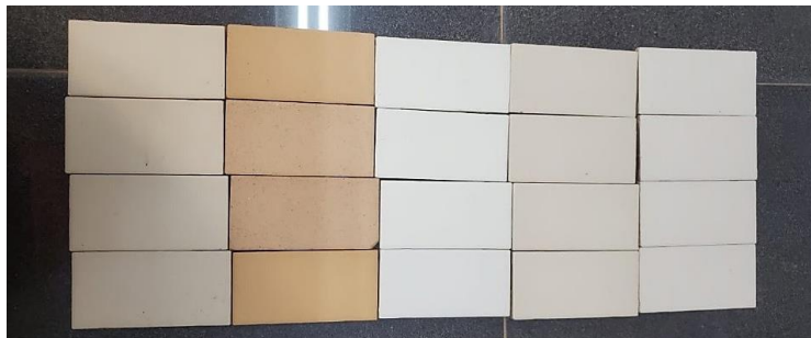
Figura 15. Placas sometidas a cocción a bajas temperaturas.
